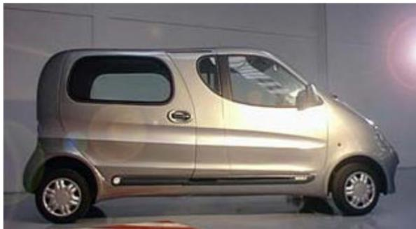
temperatura di circa -20°, che veniva utilizzata d'estate per l'impianto di condizionamento. Collegando Eolo ad una normale presa di corrente, nel giro di circa 6 ore il compressore presente all'interno dell'auto riempiva le bombole di aria compressa, che veniva utilizzata poi per il suo funzionamento. Non essendoci camera di scoppio né sollecitazioni termiche o meccaniche
